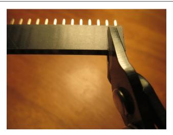
Wird der große Piezo-Lautsprecher verwendet, so sollte die Buchsenleiste mit einer Feile etwas abgefeilt werden (vorher ausprobieren). Am einfachsten geht das an der originalen, nicht bearbeiteten Seite der Buchsenleiste. Je nachdem, welches Mikrocontroller-Board verwendet wird, müssen die Buchsenleisten an den entsprechenden Stellen bestückt werden.
