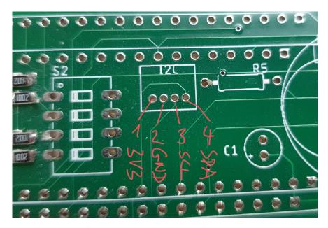
Optional kann der MultiGeiger über die I2C-Schnittstelle mit zusätzlichen Sensoren ausgestattet werden.
