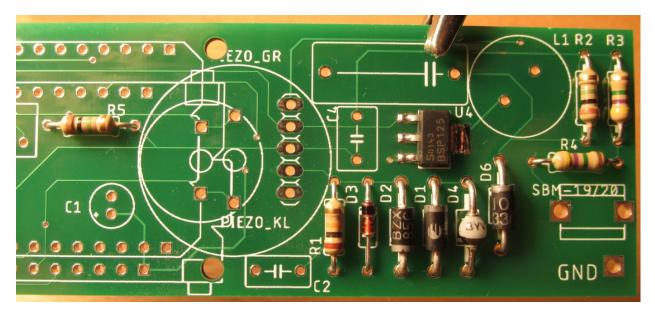
Vor dem Löten der Unterseite werden die Bauteile auf der Oberseite mit Klebeband fixiert, oder die Beinchen der Bauteile durch leichtes Auseinanderbiegen verklemmt. Dann Bauteile anlöten, Klebeband entfernen und überschüssigen Draht abschneiden.
