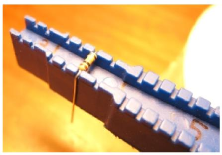
Anschließend wird die Platine mit den Widerständen und Dioden bestückt. Bei den Dioden unbedingt auf die Polarität achten! Die Kathode (Minus-Pol) ist mit einem Strich auf Platine und Bauteil markiert.
