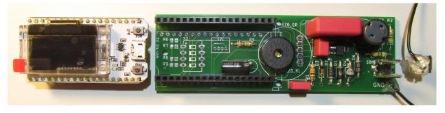
**Note:** Das dünne Glas des OLED-Grafikdisplays ist empfindlich. Bitte keine Kraft auf das Display ausüben, sondern nur auf die Mikrocontrollerplatine!
